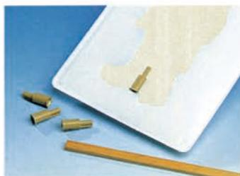
**5** Adapter mit Papier füllen, damit keine Gießmasse reinläuft. In die Rille an der Gießform klicken und die Form ausgießen. Wenn der Adapter „aufschwimmt“ – beschweren.
