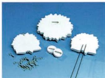
**4** Eingießerhänger oder Steckdrähte werden in die noch nasse Gießmasse gelegt. An die Drähte können z. B. Stäbe oder Schleifen befestigt werden.
