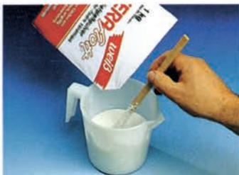
**1** Gießpulver unter Rühren langsam in das Wasser streuen und klumpenfrei durchrühren.
