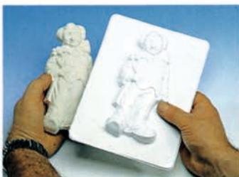
**6** Nach ca. 30–40 Min. kann entformt werden. Je länger die Trockenzeit, desto geringer die Bruchgefahr beim Entformen.
